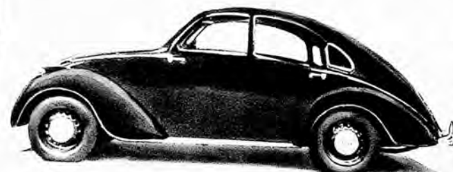
Vue de profil la 6 cyl. 2 l. 5 ADLER à 4 roues indépendantes, constitue une assez jolie réussite de carénage très poussé.
